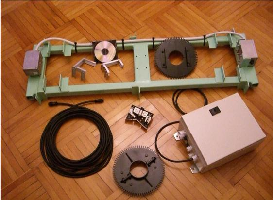
Advanced Measurement Solutions presenta il suo piu' recente sistema torsiometrico laser a fascio singolo ad allineamento ottico LTM2214 disponibile nella versione da campo con grado di protezione IP55.
